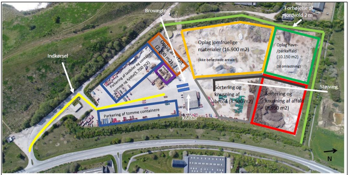
Figur 3. Ny indretning med nye arealer for modtagelse, sortering, knusning og oplag af betonaffald (grå markering), sortering og neddeling af andet affald (rød markering), og modtagelse, opbevaring og omlastning af have- og parkaffald (grøn markering). Vaskeplads/tankplads (lilla areal) og forhøjelse af eksisterende støjvold mod nord og vest (lysegrøn markering). Kilde: NIRAS. Miljømåling ekstern støj. Beregning af fremtidigt støjbidrag. Rapport nr. 21.51. 3. februar 2021. S. 9.
